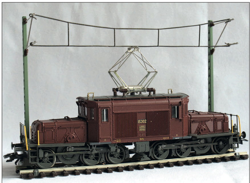
Seetal-krokodillen fra Märklin i H0, type De 6/6, er også en fin modell med stangdrift.
